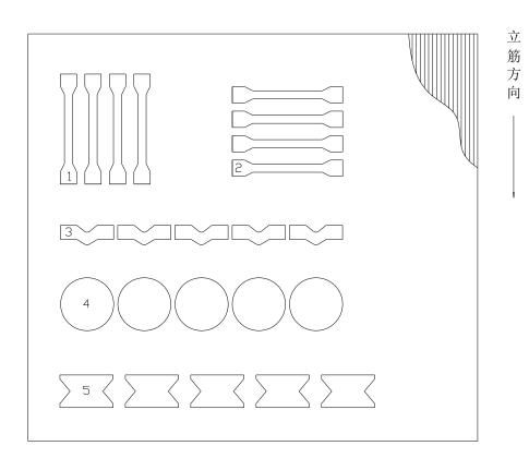
1-纵向拉断力及断裂伸长率试样; 2-横向拉断力及断裂伸长率试样; 3-撕裂力试样; 4-平面压缩力试样; 5-垂直压缩力试样 图 1 试样截取示意图
